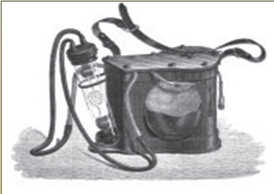
1862 Dumas et Benoît's Electrical miner lamp
